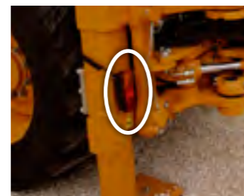
Koncová světla stroje mohou být umístěna buď na rámu stabilizátorů při jízdě nebo přímo na kabině při práci s podkolem. Tím je zajištěna jejich maximální viditelnost a ochrana.
